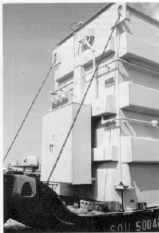
Рисунок 1 – Транспортировка трансформатора – представлены стяжки и блокады
